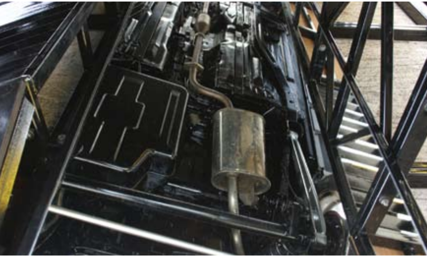
• ใส่อะไหล่ไว้ใต้ท้องรถ เพื่อให้เก็บระบบกันสะเทือนฟิวส์โรดส์ ด้านหลังทอร์ชันบาร์ มี PANART ROD ตามขวาง และทรลิ่งอาร์มบนบนกับตัวรถช่วยเพิ่มการยึดเกาะถนน
