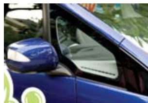
กระจกสามเหลี่ยมตรงกระจกมองข้างถูกขยายขนาดขึ้นจากรุ่นเดิม ทำให้ช่วยเพิ่มทัศนวิสัยในการมองทางด้านข้างได้ดีขึ้น
