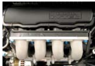
เครื่องยนต์ L15A ยุคปรับปรุงใหม่ หันมาใช้ฝาสูบแบบ i-VTEC พร้อมกับระบบลิ้นปีกผีเสื้อไฟฟ้า รีดกำลังขึ้นมาได้ที 120 แรงม้า
